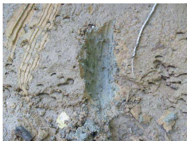
*La part d'argile devient plus forte au niveau du fond du lit où apparaissent des traces de fer réduit (T002)*
